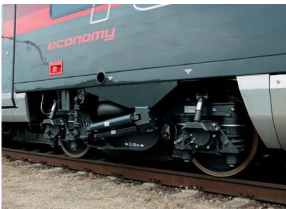
Drehgestell mit Zugsicherungsantennen (Afmpz)
